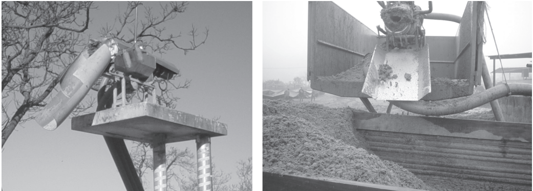
Figura 3.2 • Equipamento de separação de sólidos e líquidos do chorume
